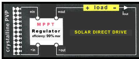
En l'absence de batterie, le couple et la vitesse d'un moteur (ex. pompe hélicoïdale) s'adaptent parfaitement, matin, midi et soir, aux variations de luminosité. Par ailleurs, tout en ayant un temps de réponse < 0,1 seconde, notre régulateur MPPT soulage les transmissions mécaniques : brutalement connecté à un moteur chargé, il l'alimente avec une tension immédiatement abaissée, puis rétablie linéairement en quelques secondes.
